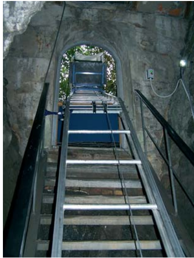
Transportband aus der Höhle nach draußen zum Container; Fotos: A. Ipsen
