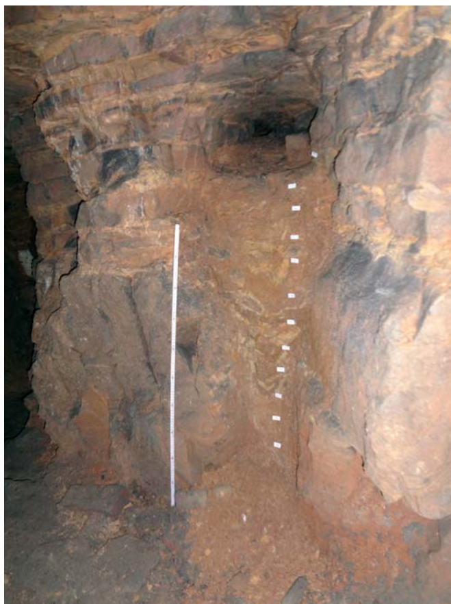
Abb. 13: Übersicht einer phantomisierten senkrechten Kluft im Übergang der Gesteine der Tonplattenfazies zum Trochitenkalk
