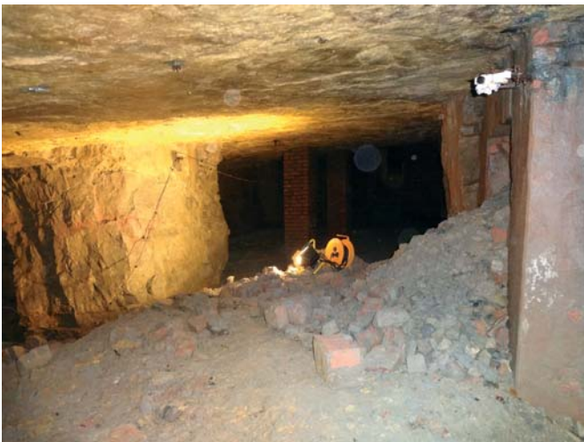
Abb. 3: Im Pfeilerbau wurden massige Werksteine der Trochitenkalkfazies abgebaut. Die Gesteine der „Tonplattenfazies“ an der Decke sind in diesem Steinbruchbereich nicht nachgebrochen.
