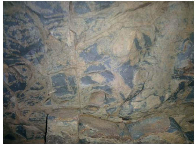
Abb. 9: Gut zu erkennen ist die Zerlegung des Gesteinskörpers an der Steinbruchfirse in zahlreiche kleinräumlichere Gesteinsquader, die durch Klüfte oder Schichtflächen voneinander gelöst sind. Entlang dieser Fugen ist das Eindringen der Phantomisierungsfront in das „gesunde“ Gestein durch die damit verbundene Farbänderung von grauen Gesteinsfarben zu gelblich-braunen Gesteinsfarben deutlich zu sehen.
