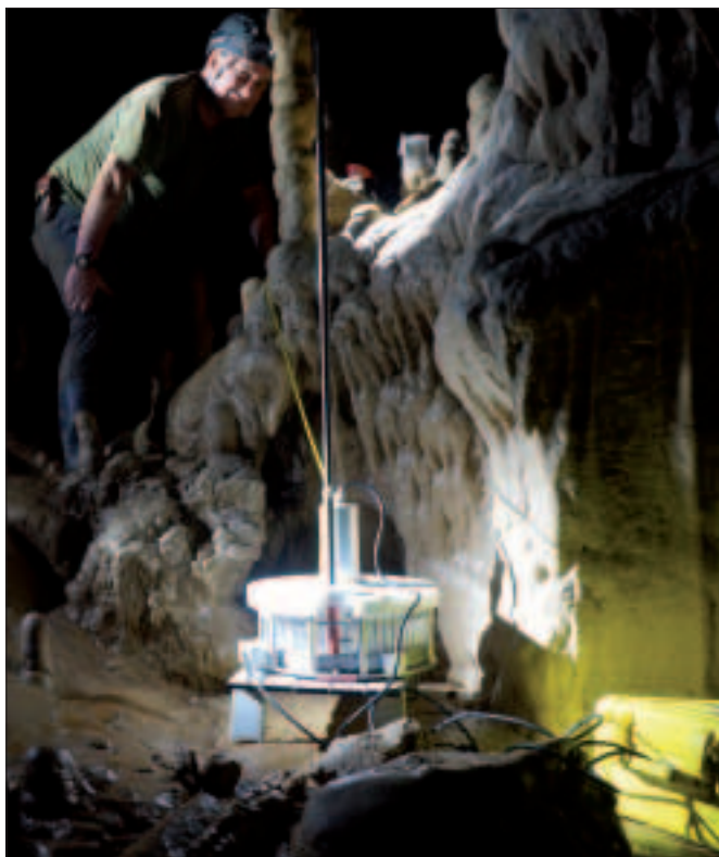
Abb. 1 (links): Der Prototyp eines automatischen Wassersammlers beprobt in der Yok Balum-Höhle in Belize alle drei Tage Tropfwasser für die Untersuchung der Wasserchemie – die Proben werden dann zusammen mit Temperatur- und CO 2 -Messungen zur Kalibration von Klimarekonstruktionen eingesetzt; Foto S. Breitenbach. Abb. 2 (oben): Ein Messgerät erfasst Lufttemperatur, Luftdruck und CO 2 -Gehalt der Luft in regelmäßigen Abständen – diese Informationen geben Auskunft über die Ventilationsdynamik in der Bleßberghöhle; Foto J. Leonhardt
