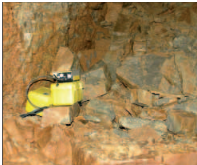
Abb. 1 (links): Der Prototyp eines automatischen Wassersammlers beprobt in der Yok Balum-Höhle in Belize alle drei Tage Tropfwasser für die Untersuchung der Wasserchemie – die Proben werden dann zusammen mit Temperatur- und CO 2 -Messungen zur Kalibration von Klimarekonstruktionen eingesetzt; Foto S. Breitenbach. Abb. 2 (oben): Ein Messgerät erfasst Lufttemperatur, Luftdruck und CO 2 -Gehalt der Luft in regelmäßigen Abständen – diese Informationen geben Auskunft über die Ventilationsdynamik in der Bleßberghöhle; Foto J. Leonhardt
