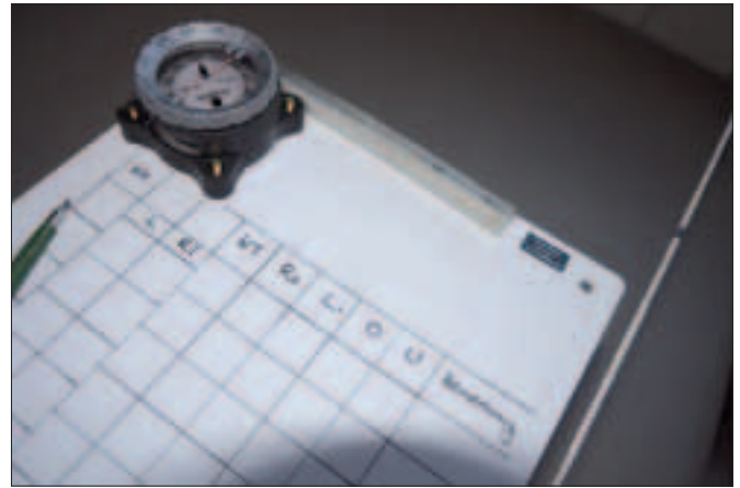
Abb. 5: Messplatte, angelegt an die Führungsleine
