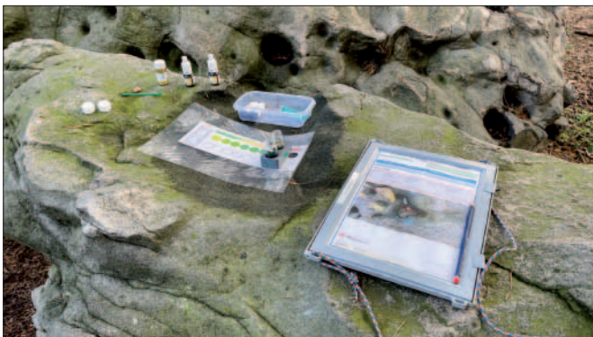
Abb. 9: Equipment zur Bestimmung des SiO 2 -Gehalts im Wasser.
