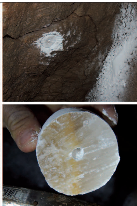
Abb. 15: Der Große Stalagmit und der für die U/Th-Datierung entnommene Bohrkern; Fotos S. Kempe.
