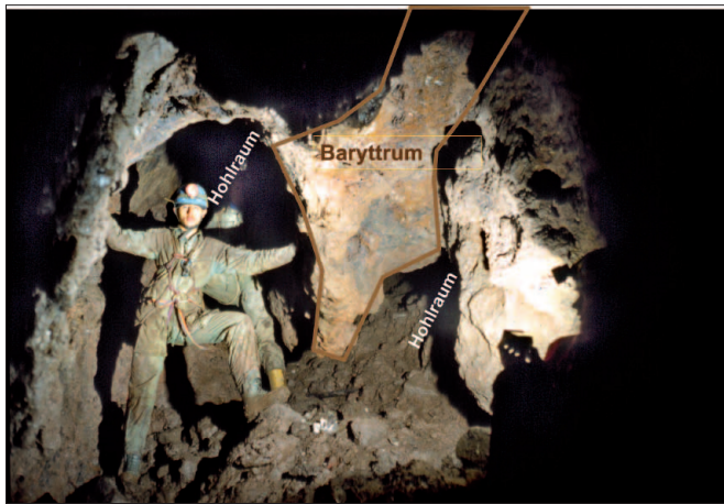
Abb. 29: Ein Erzgang im Frankenbergsschacht: in der Mitte das Trum aus Baryt und Quarz, außen stand Siderit an, der sekundär zu Goethit und Limonit umgewandelt war – diese beiden Erze wurden abgebaut; Foto S. Kempe.
