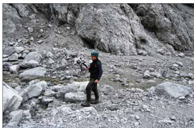
Geländeaufnahme des Terrains der ehemaligen Eiskapelle mit Handscanner L2 Pro im Oktober 2025; Foto A. Wolf.
